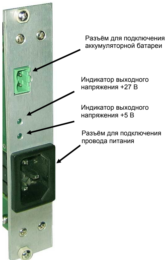
Рисунок 3 – Расположение элементов на передней панели.
