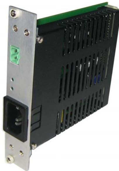
Рисунок 1 – Внешний вид модуля ИП MIC-Power
